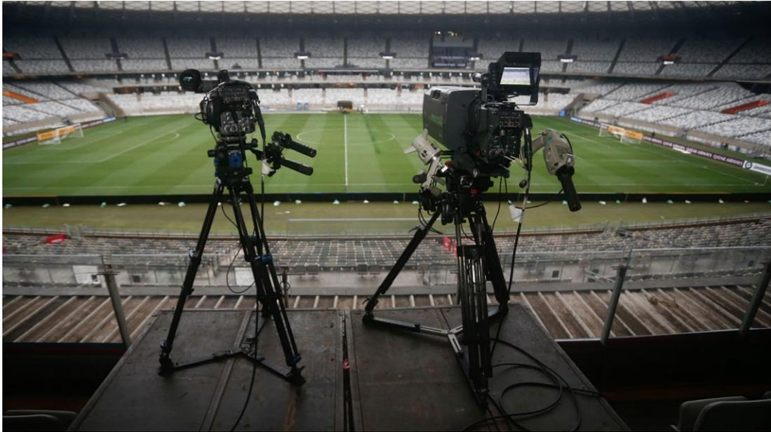
**Câmera de ângulo reverso (7):** Nível de inclinação em uma pequena plataforma elevada na frente da câmera principal, instalada em uma posição central localizada entre as linhas de 16m.
