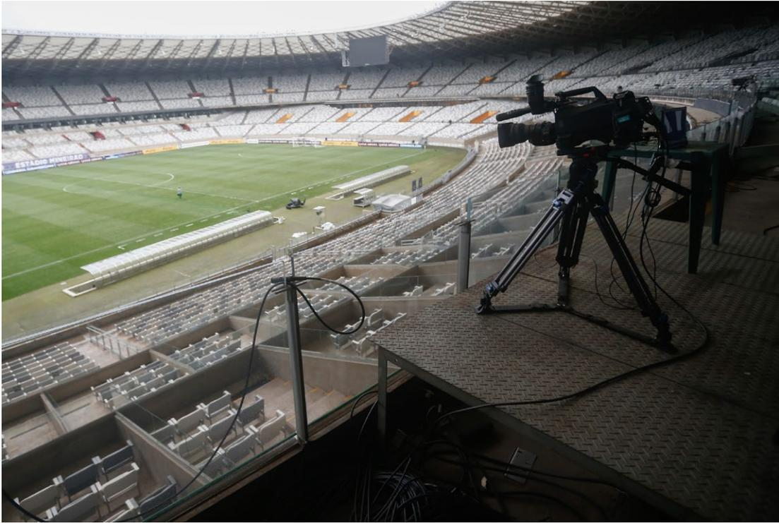
**Câmeras da linha de impedimento (5 e 6):** Duas câmeras instaladas no suporte principal exatamente nas linhas de 18 jardas, no mesmo nível ou mais alto que a plataforma da câmera principal.
