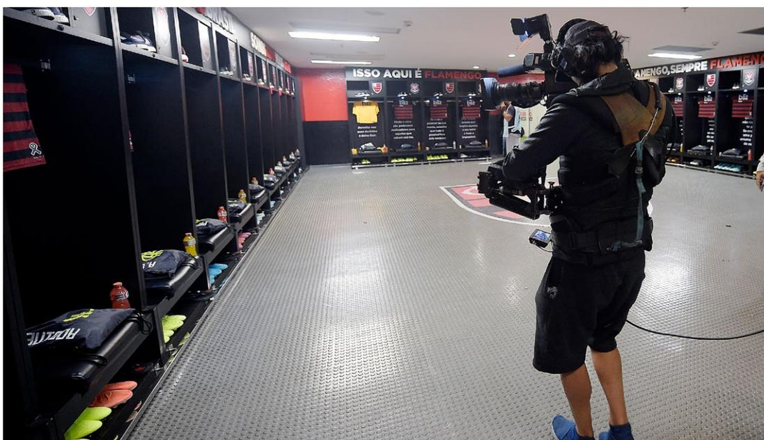
**Steadicam (17):** Câmera em movimento por toda a linha lateral. Requer a movimentação do cinegrafista e seus assistentes (em alguns casos utiliza-se um sistema inalâmbrico, que não requer cabos).
